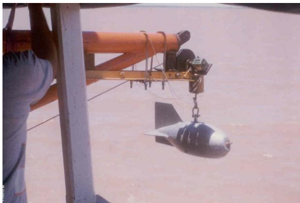
AMOSTRADOR DE SEDIMENTOS DE FUNDO
