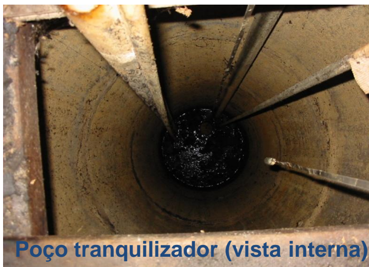
Seção de réguas e poço tranquilizador (linígrafo)
