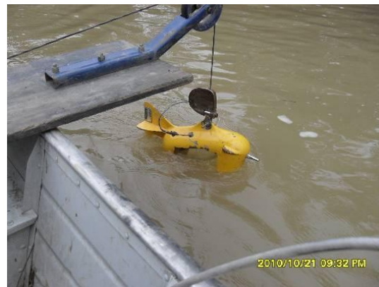
AMOSTRADOR DE SEDIMENTOS EM SUSPENSÃO
